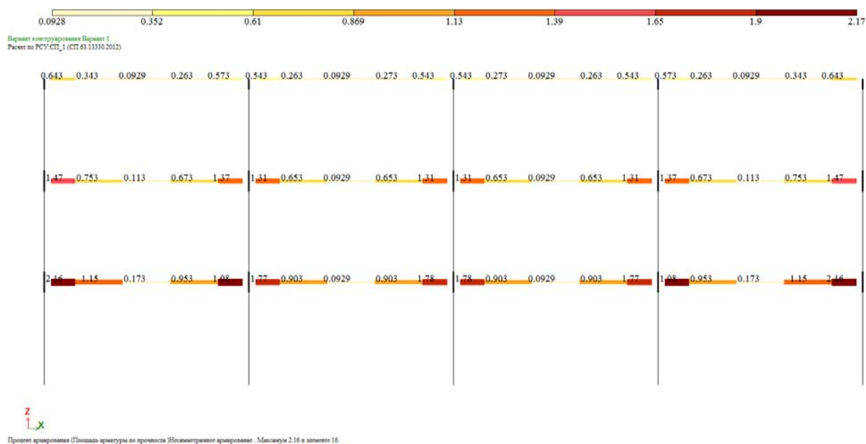
Рис.7 Расчетное армирование ригелей
