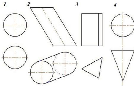
12. На каком чертеже расстояния между ребрами спроецированы в натуральную величину?
