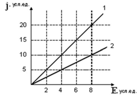
4. На рисунке представлена вольтамперная характеристика резистора, подключенного к источнику тока, с ЭДС 16 В. Через резистор протекает ток 2,5 А. Чему равно внутреннее сопротивление источника тока?
