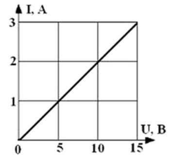
5. На рисунке представлены результаты экспериментального исследования зависимости силы тока в цепи от значения сопротивления, подключенного к источнику постоянного тока. Определите КПД источника при сопротивлении 4 Ом.
