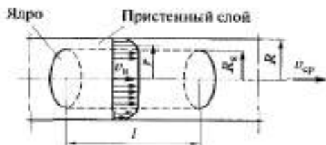
Модель непрерывного движения бетонной смеси в бетонопроводе
