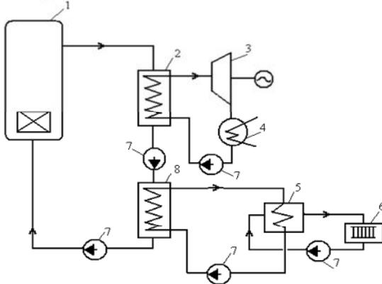
1- атомный реактор; 2 - парогенератор; 3- турбогенератор; 4 - конденсатор;
