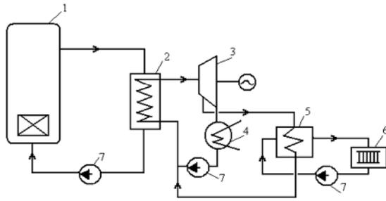
1- атомный реактор; 2 - парогенератор; 3- турбогенератор; 4 - конденсатор;
