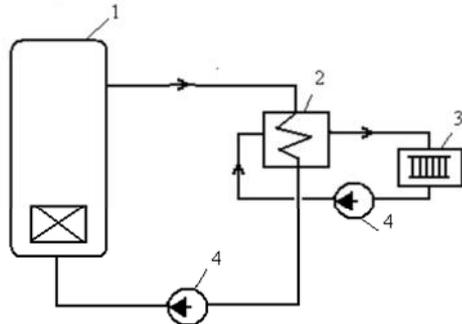
1- атомный реактор; 2 - сетевой теплообменник;
